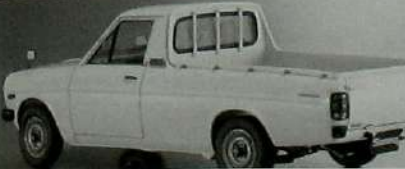
全長: 4140mm, 全幅: 1495mm, 全高: 1395mm, ホールベース: 2530mm, タレド前/後: 1250mm/1245mm, 車軸距離: 720kg, エンジン: A12型 OHV水冷直列4気筒、総排気量: 1171cc, 最高出力: 64ps/5400rpm, 最大トルク: 9.7kgm/3200rpm, トランスミッション: 4速フロアシフト, 乗車定員: 2名.
