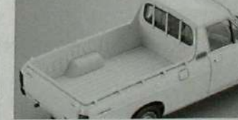
全長: 4140mm, 全幅: 1495mm, 全高: 1395mm, ホールベース: 2530mm, タレド前/後: 1250mm/1245mm, 車軸距離: 720kg, エンジン: A12型 OHV水冷直列4気筒、総排気量: 1171cc, 最高出力: 64ps/5400rpm, 最大トルク: 9.7kgm/3200rpm, トランスミッション: 4速フロアシフト, 乗車定員: 2名.
